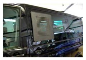
Der Lüftungseinsatz für Schiebefenster eignet sich ebenfalls hervorragend zur Versorgung des Fahrzeugs mit Frischluft. Genau wie der Frischlüfter ist auch er mit einem Mosikitonetz ausgestattet, durch die Belüftungskiemen selbst dringt kein Regenwasser ein.
